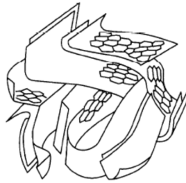
Figure 11. Représentation schématisée de la structure d'un charbon activé (Rodríguez-Reinoso et Molina-Sabio, 1998).
